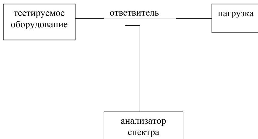
Рис. 9 Схема рабочего места для измерения спектральной плотности мощности при передаче
